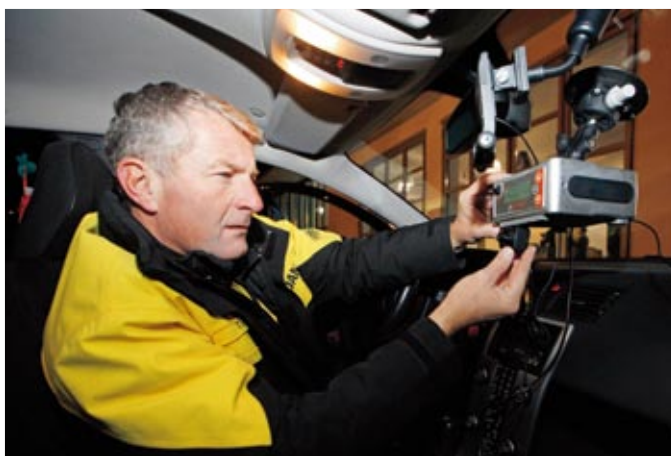
Hochtechnologie im Einsatz: Mit speziellen Geräten wurden für die Sekundenschlaf-Studie Hirnströme gemessen und Blickbewegungen mit Videokameras erfasst.
